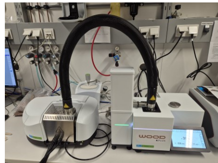
STA-FTIR zur simultanen thermischen Analyse und Charakterisierung gasförmiger Zersetzungsprodukte (©Foto: Wood K plus)
