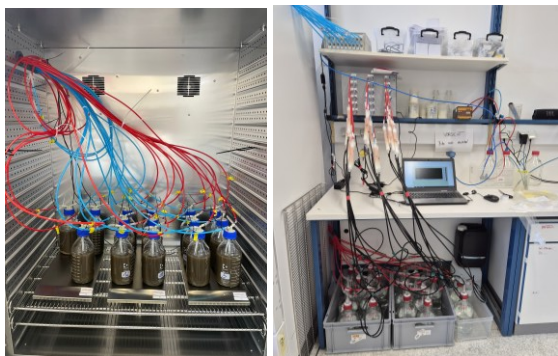
Bioabbausystem Aquatisch zur Untersuchung der biologischen Abbaubarkeit von Materialien mit kontinuierlicher CO 2 -Erfassung (©Foto: Wood K plus)
